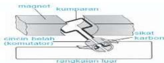
Gambar 3 rangkaian generator DC
