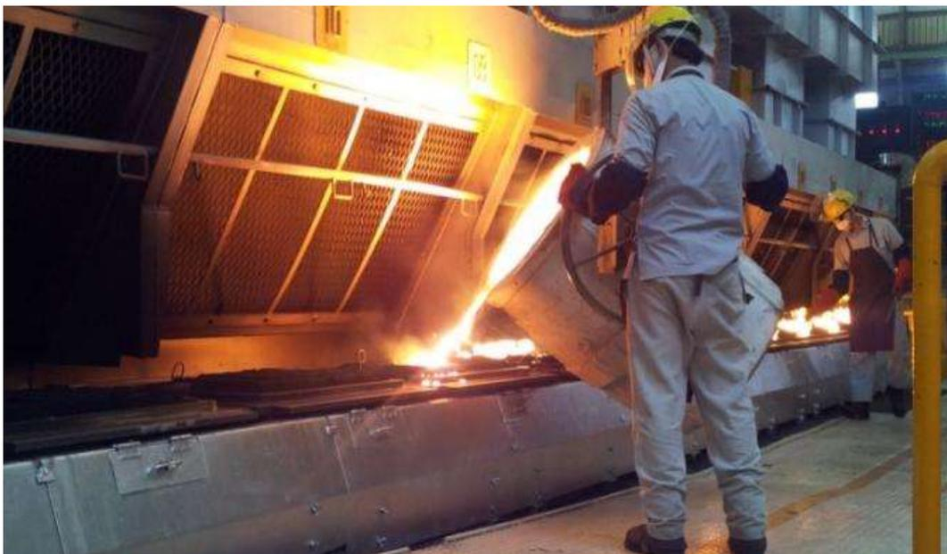
Gambar 2.2. Proses Pengecoran *Cylinder Head*
