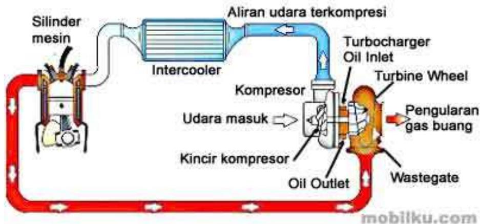
Gambar 2.6. Langkah Kerja *Turbo Charger*
