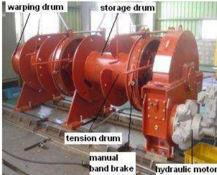
Gambar 2 *Windlass* bertenaga hidraulik
