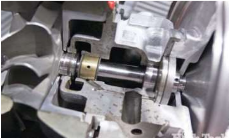
Gambar 3 CHRA pada Turbocharger Mesin Induk Kapal (Maritime. Edu 2007, Belajar Media Online)
