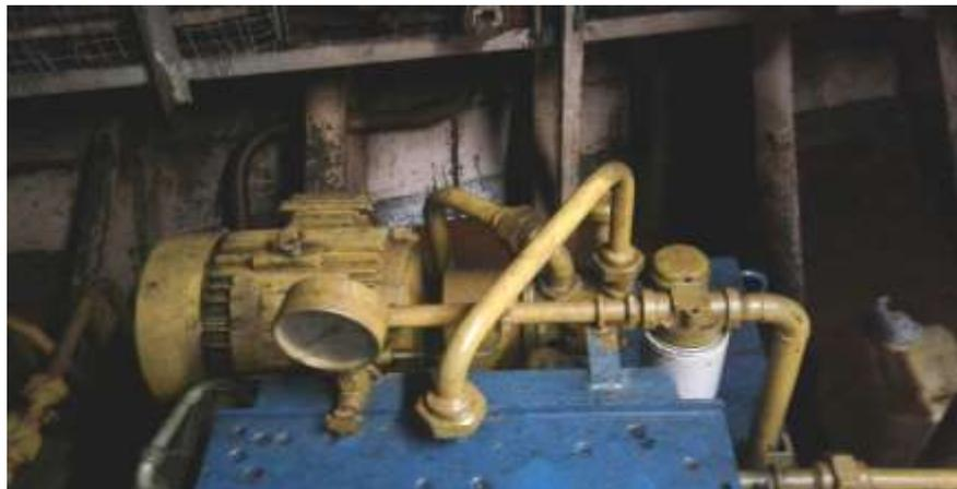
Gambar 6 : Pompa Hidrolik.
