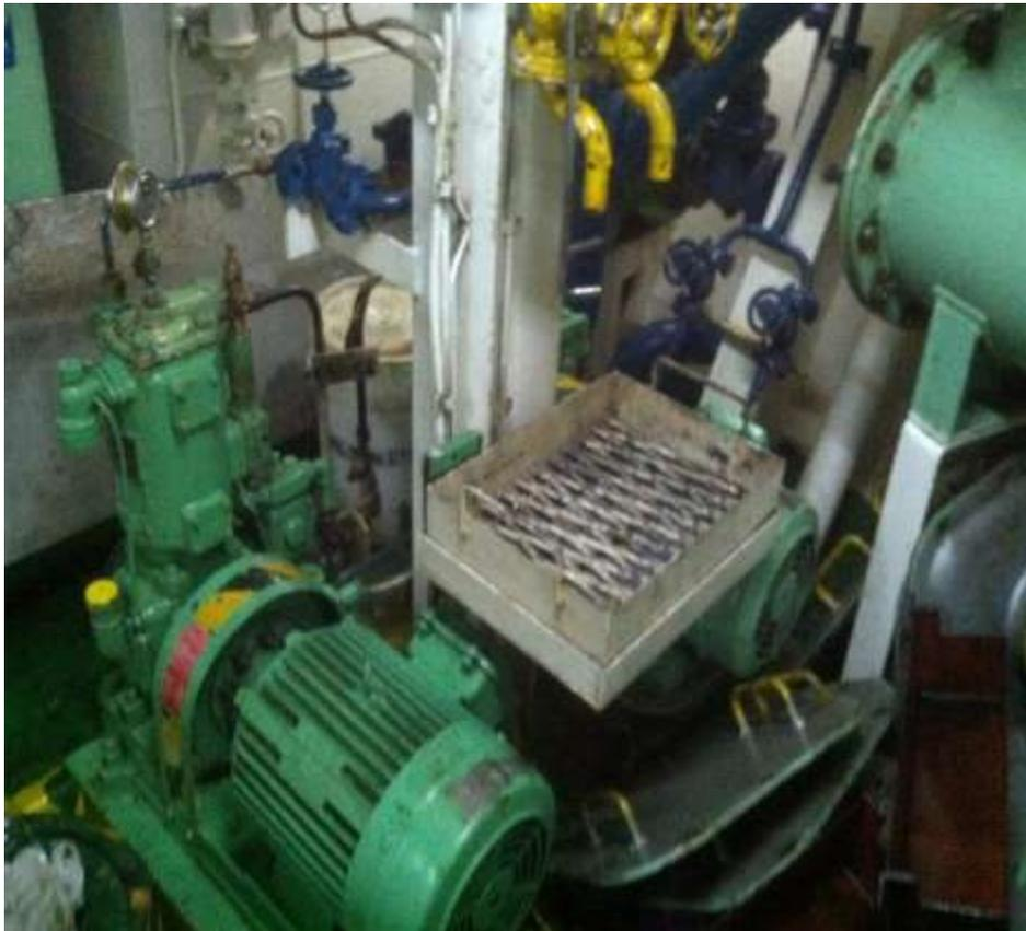
Gambar 1. kompresor udara
