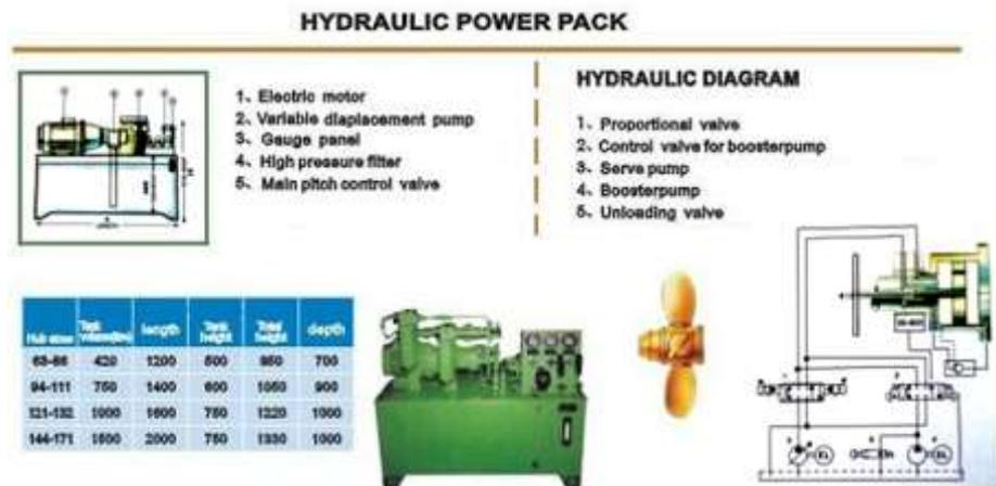
Gambar 2.10 Konstruksi Hydraulic Power Pack
