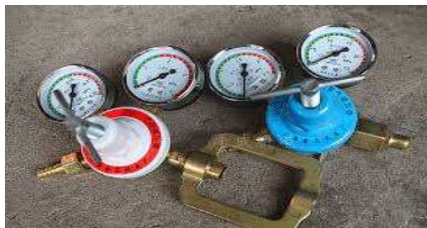
Gambar 9 Regulator Tabung Oksigen Sumber : Pelabuhan Juwana
