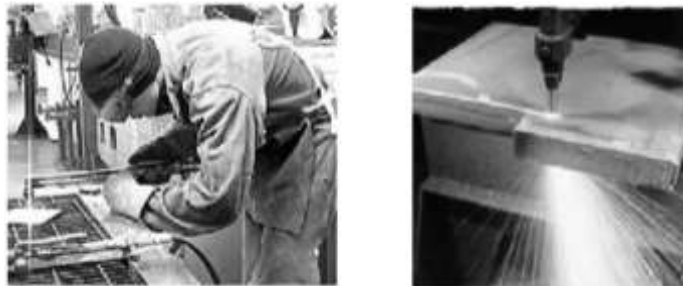
Gambar 11. Pemotongan Logam dengan oxy-acetylene Sumber : teknikmesinmanufaktur.com
