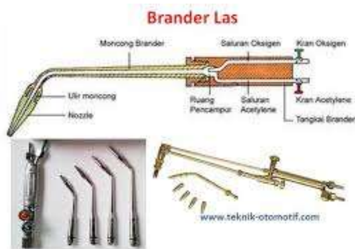
Gambar 14. Bagian Brander potong las Oxy-acetylene Sumber : welding oxy-acetylene.com
