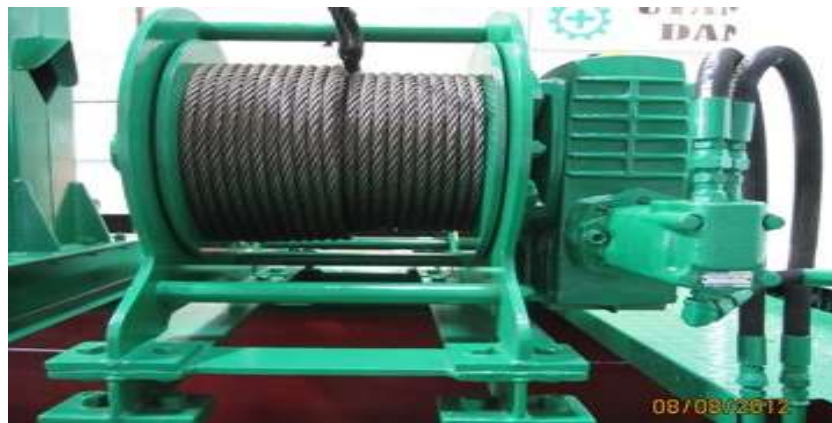
Gambar 3 Whinc dengan sistem penggerak hidrolis
