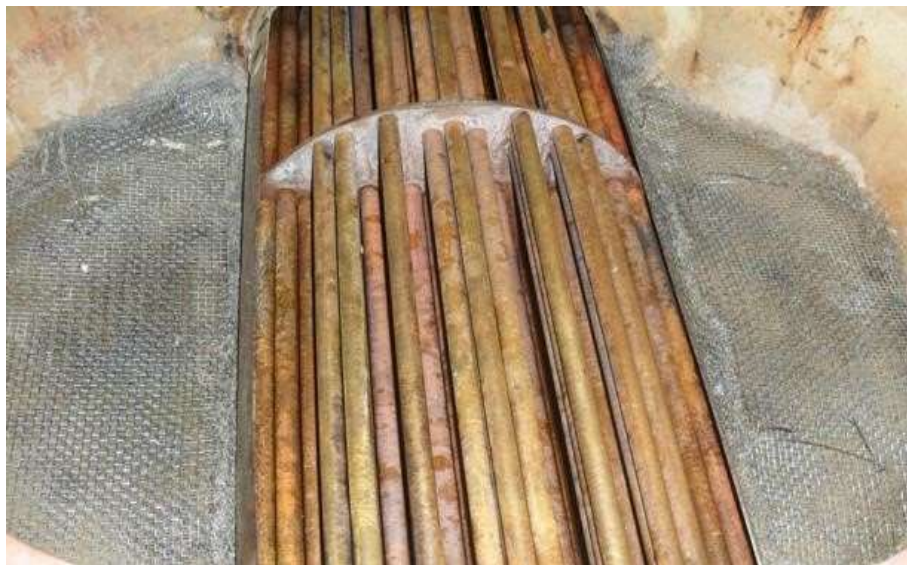
Gambar 3 kondensor (Juan 2006 Komponen Fresh Water Generator , BIP : Jakarta)
