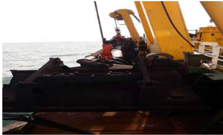
Gambar 9 : Draghead TSHD. King Arthur 3
