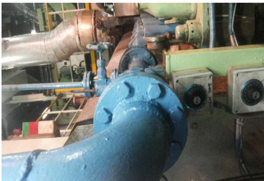
Gambar 8 Pipa Pendingin mesin induk KM.Sinar Papua
