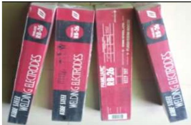
Gambar 3 elektroda/kawat las
