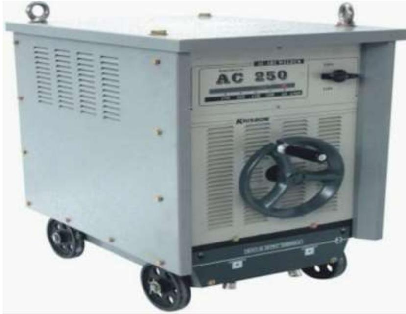
Gambar 1 Mesin/trafo las
