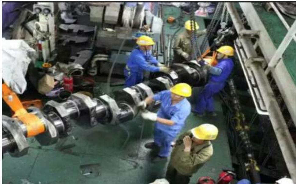
Gambar 4. Pemasangan crankshaft KM. NIKI SEJAHTERA
