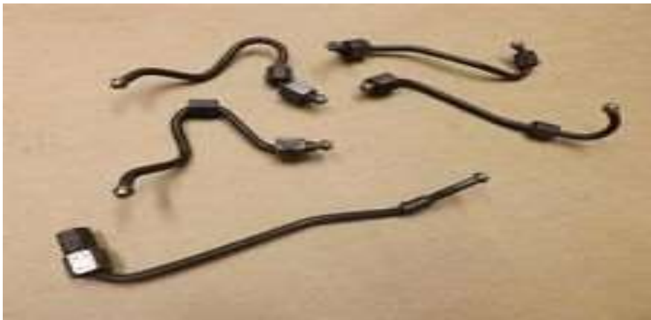
Gambar 3 : Over flow pipe (Fendi Adi Wibowo 2013 Perawatan injector , Semarang : Jawa Tengah)
