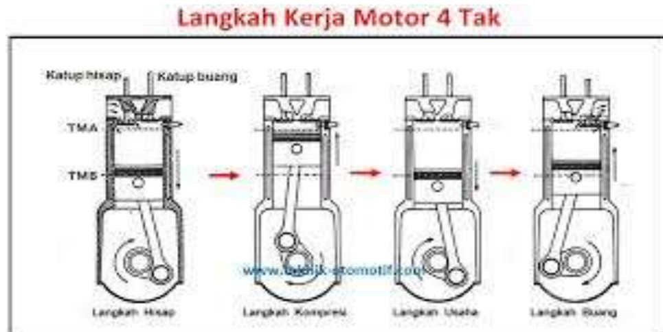
Gambar 1: Langkah kerja motor 4 tak.
