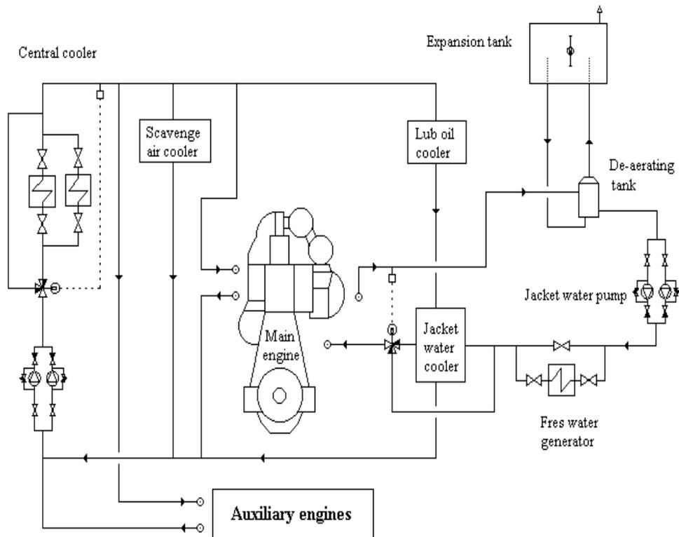
Gambar 2.4 Cara Kerja Pendingin Air Tawar Motor Induk
