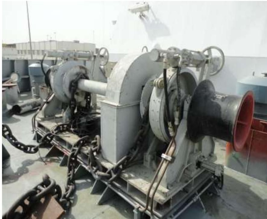
*Gambar 2.1 Konstruksi Pendukung Mesin Jangkar*
