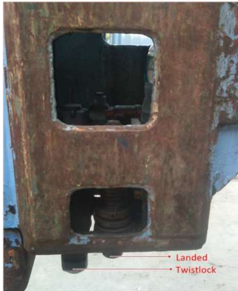
Gambar 7 Komponen Twist Lock pada Rubber Tired gantry Crane
