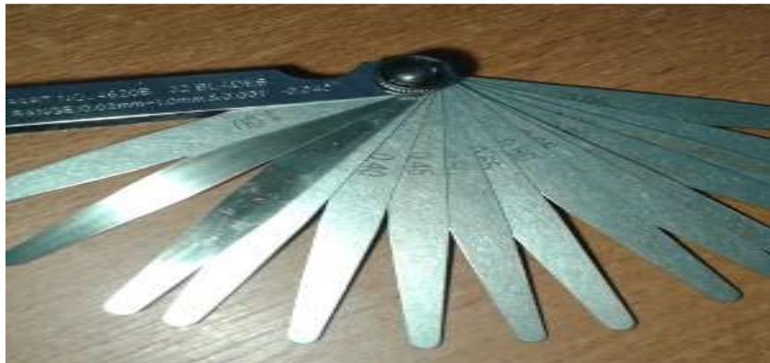
**Gambar 10** Alat Pengukur Celah Katup
