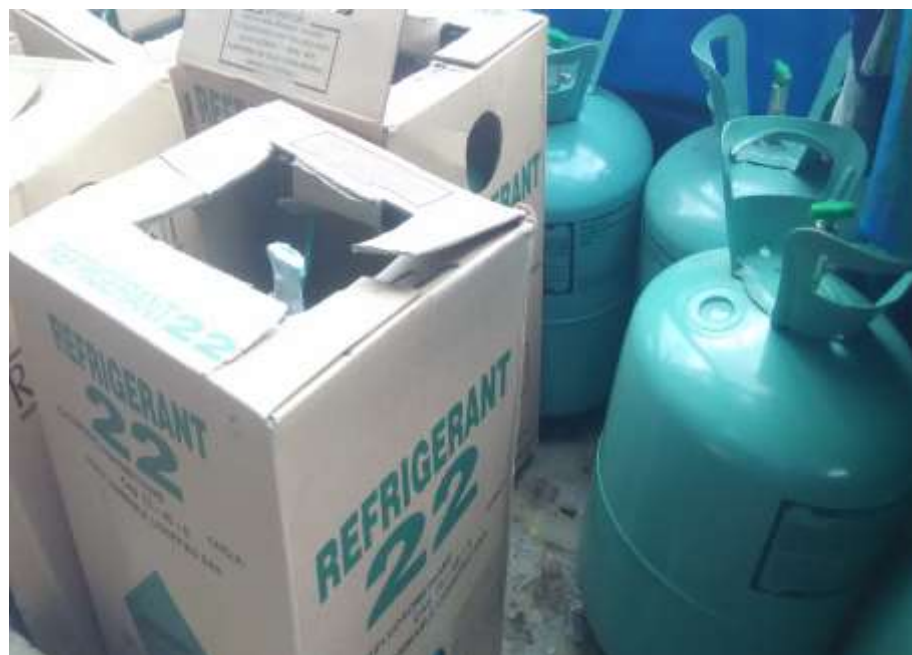
Gambar 13: Refrigerant (sumber : M.Syamsudin 2017 Pemeliharaan Refrigeran : Juwana)
