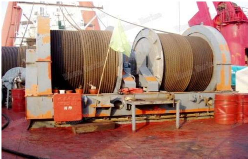
**Gambar 7** Winch Kapal untuk Ramp Door atau moorin
