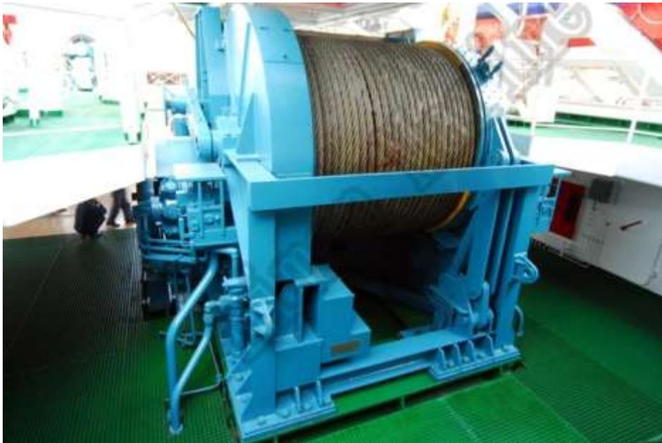
**Gambar 1** Whinc dengan sistem penggerak hidrolik
