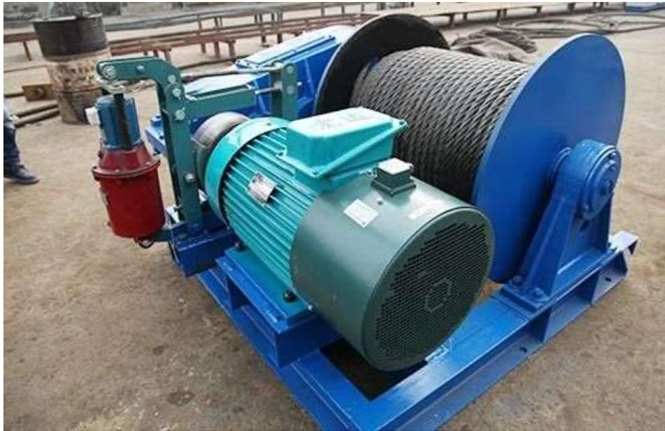
**Gambar 2** whinc dengan penggerak motor listrik
