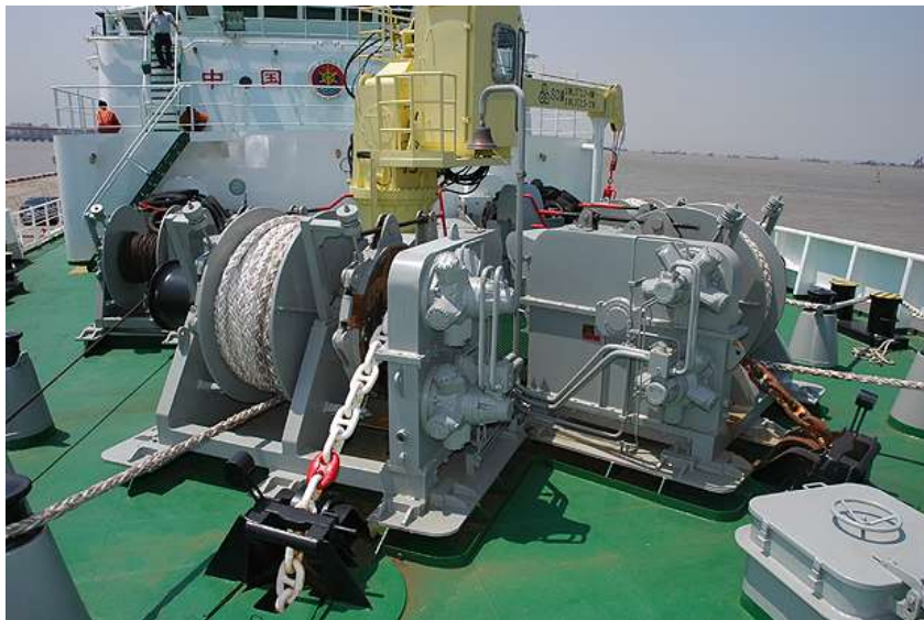
Gambar 2 Mesin jangkar elektrik/listrik
