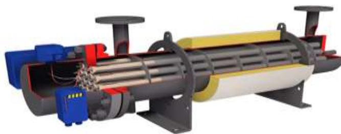
Gambar : 5. Sheel dan Tube Cooler (Sumber : Wiranto Arismunandar. Mengenal-jenis-jenis-pendingin .1983)
