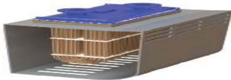
Gambar : 6. Box Cooler (Sumber : Wiranto Arismunandar. Mengenal-jenis-jenis-pendingin (1983))
