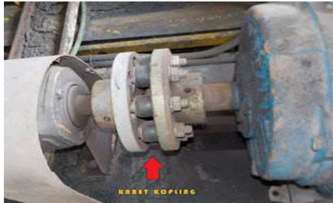
Gambar 2.4 Bagian Karet kopling Sentrifugal Sumber Dokumen Prbadi 2018
