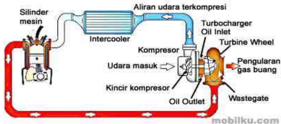
Gambar 2.3 Aliran Udara Bilas Pada Turbo
