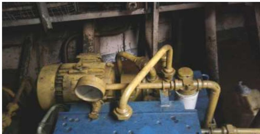
Gambar 2.7 : Pompa Hidrolik.
